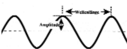
Abb. 2: Transversalwelle Gängige elektromagnetische Wellen sind »Transversalwellen«. Sie schwingen senkrecht zur Ausbreitungsrichtung. Die Abstände zwischen Wellenbergen bzw. Wellentälern geben die Wellenlänge und damit indirekt die Frequenz vor.
